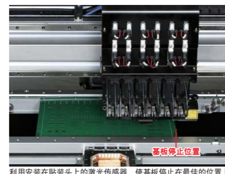
利用安装在贴装头上的激光传感器, 使基板停止在最佳的位置上
